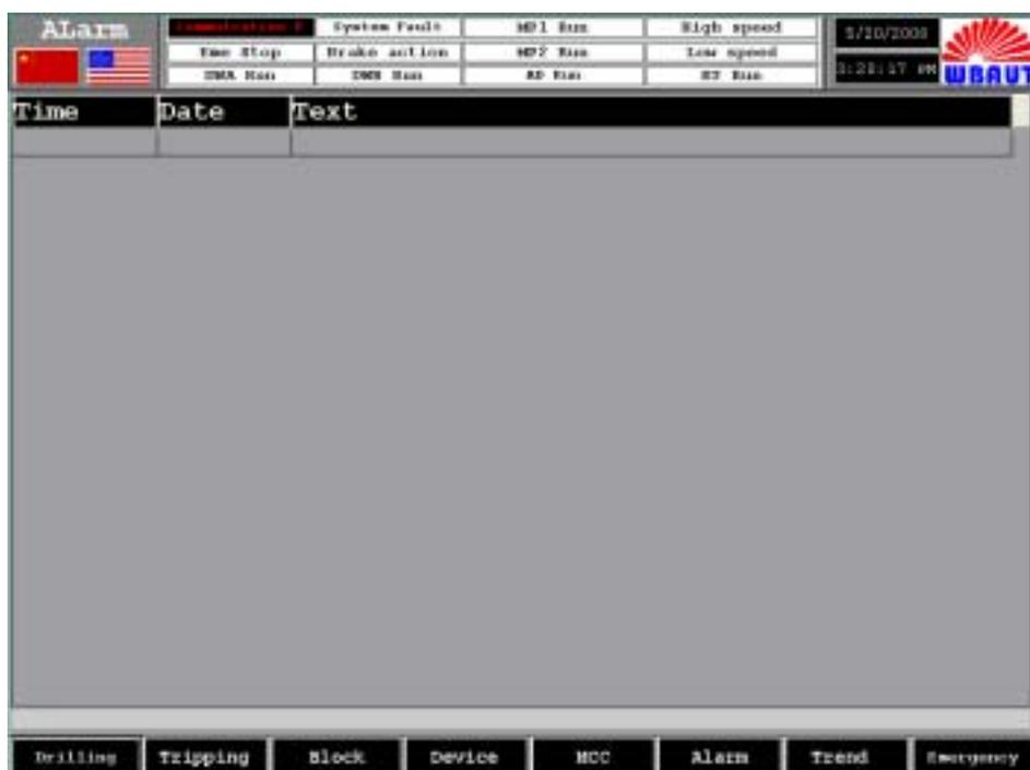
Схема 6-14: Изображение сигнализации неисправностей
