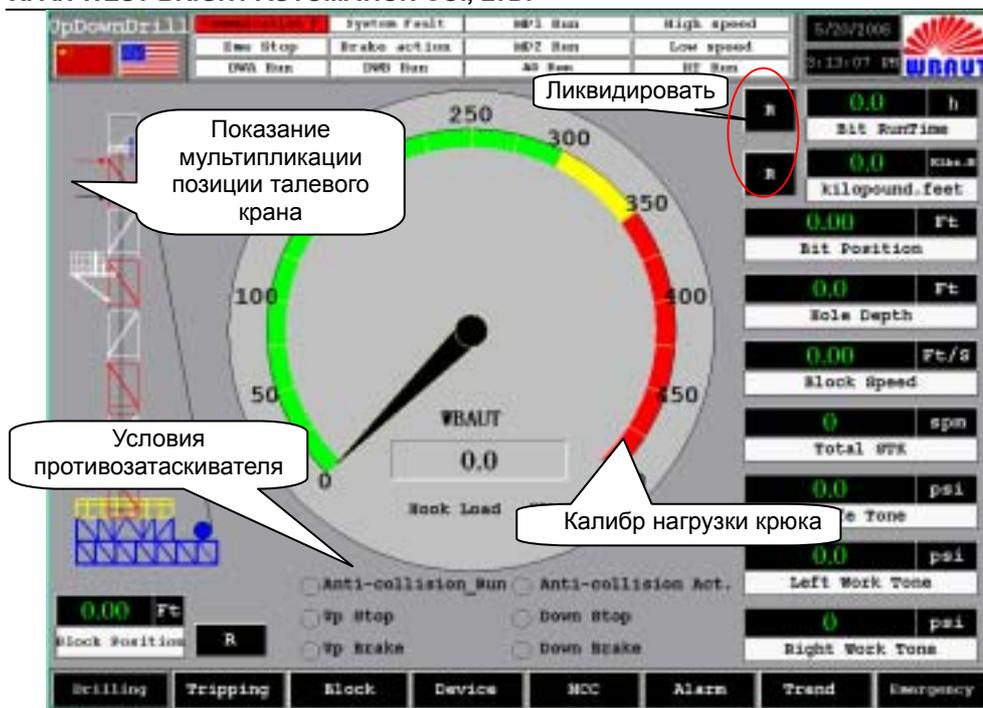
Схема 6-5: Изображение подъема и спуска буровой установки
