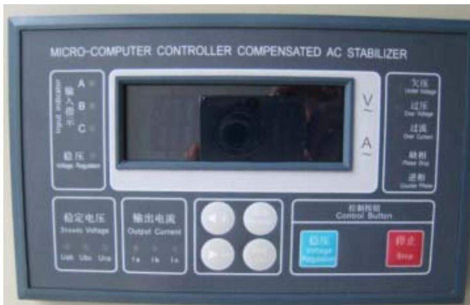
Схема 1-2: Операционный панель стабилизатора напряжения
