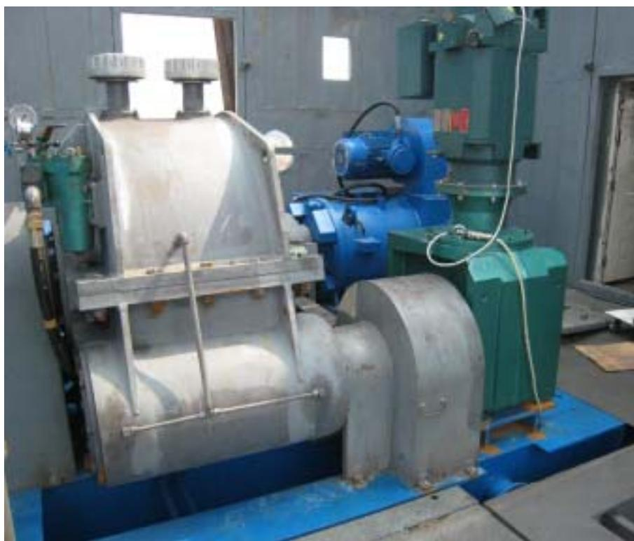
Схема 4-3 Приводная система лебедки
