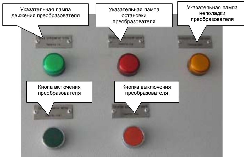
Схема 4-8 Компоновка шкафов автобурильщика
