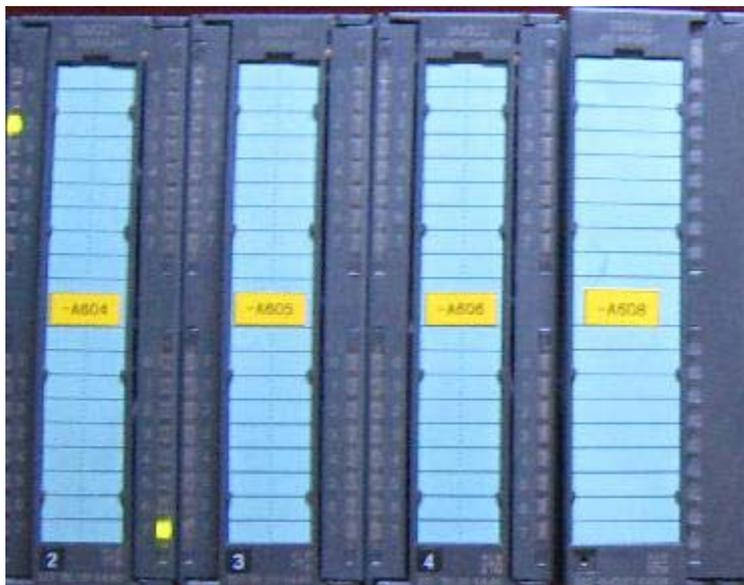
Схема 2-13 Входной и выходной модуль
