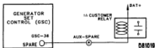
Типичная схема цепи для активного запасного выхода, находящегося в состоянии с низким уровнем напряжения. (1A) Реле, устанавливаемое заказчиком.
