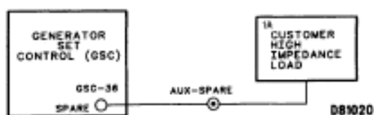
Типичная схема цепи для активного запасного выхода, находящегося в состоянии с высоким уровнем напряжения. (1A) Нагрузка с высоким импедансом, устанавливаемая заказчиком.
